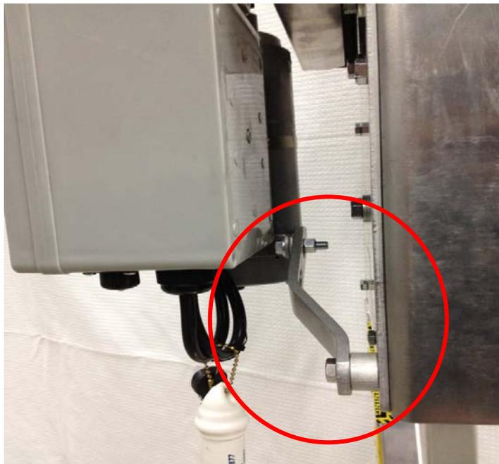
**N°8** En cas de panne utiliser cet outil à l'aide d'une visseuse pour monter ou descendre l'élévateur.
