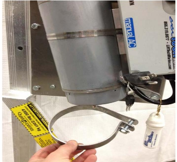
**N°7** Fixer l'étrier au support avec les vis puis brancher le moteur et profitez.
