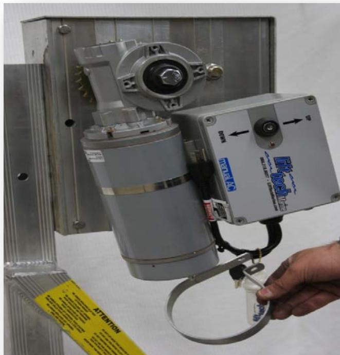
N°8 En cas de panne utiliser cet outil à l'aide d'une visseuse pour monter ou descendre l'élévateur.
